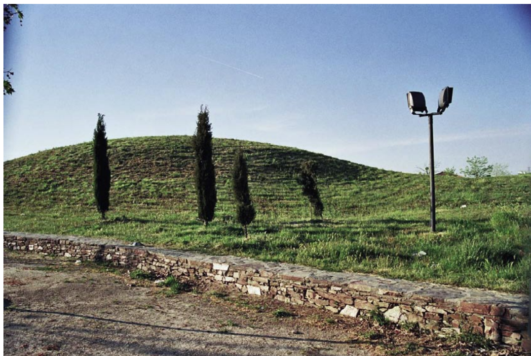
Ejemplo de alumbrado inútil e innecesario. Dada la posición de los proyectores, el 50 por ciento del flujo lumínico escapa al cielo. Parque Oeste. Alcorcón. Madrid. Foto: Fernando Rodríguez.
